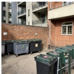
Containere placeret mindre end 5 meter fra bygning
