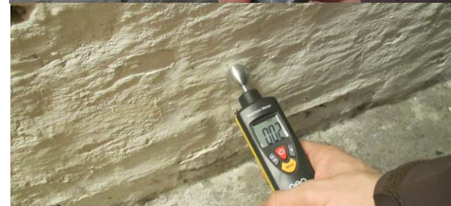
Fugtmålinger fra kælder.
